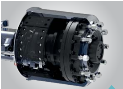
Durch unterschiedliche Bremswellenposition kombinierbar mit verschiedenen Federungssystemen.
