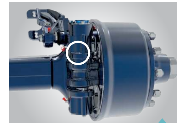
Lenkgehäuse bei Geradeausfahrt (0-Stellung)
