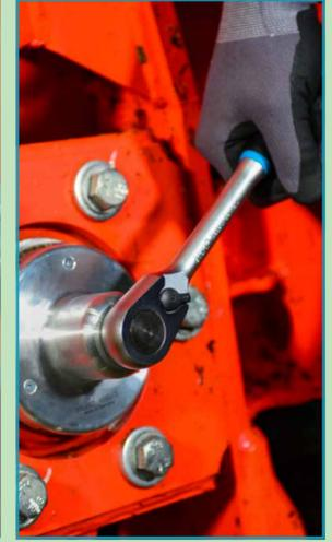
Betätigung mittels Knarre durch eingebrachte 12,5 mm (1/2") 4kt.-Aufnahme
