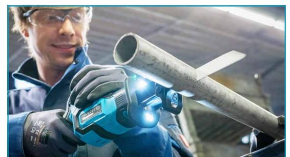
Integriertes LED-Licht mit Nachleuchtfunktion
