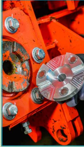
Werkzeug mit passendem Profil zum Schnellkuppler
